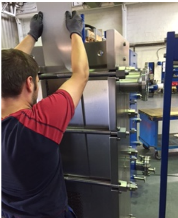
Abbildung 5: Einbau Teil II in Richtung der beweglichen Druckplatte
