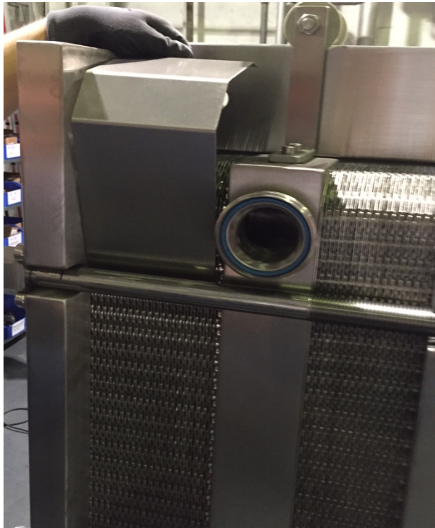
Abbildung 7: Einschoben des ersten Kopfteils zwischen Plattenpaket und Spannschrauben von oben
