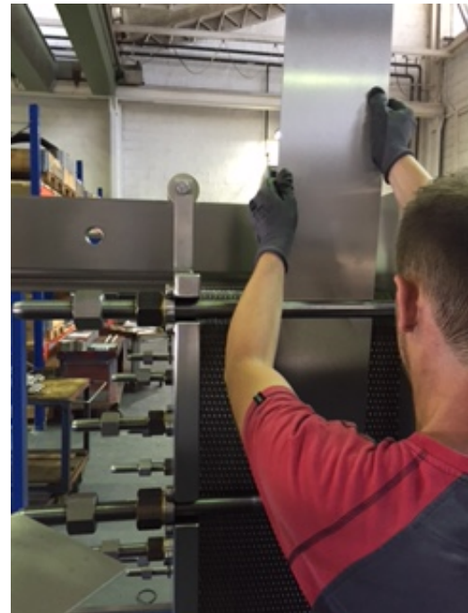
Abbildung 2: Einbau Teil I in Richtung der fixen Gestellplatte
