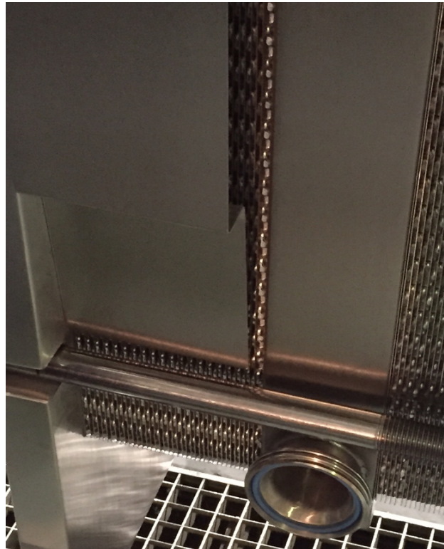
Abbildung 11: ... und an der untersten Spannschraube eingehängt
