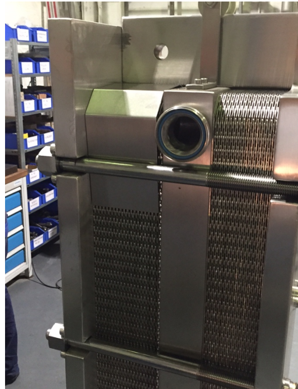
Abbildung 8: Apparat nach dem Einbau des ersten Kopfteles
